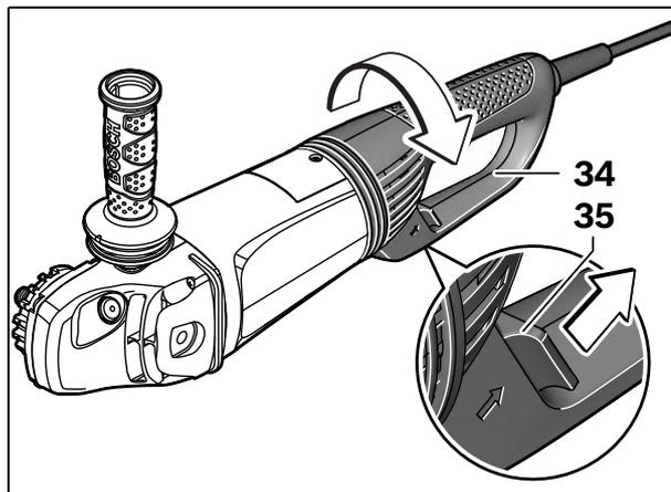
Главную рукоятку **34** можно повернуть на  $90^\circ$  влево или направо. Таким образом выключатель может быть установлен в более удобное для работы положение, например, для отрезных работ с кожухом для отсасывания и направляющими салазками **18** или для левши.
