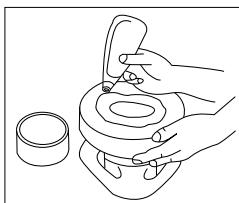
7. Заменить периферийный чехол с коротким ворсом на чехол с более длинным ворсом и натянуть его на периферийную подушку. Убедитесь в его чистоте. Удалить слой воска в том же порядке, в котором он наносился.
