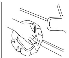
6. При работе в плохо доступных местах (например, зеркала заднего вида, бамперы, дверные ручки и пр.), снять периферийный чехол с периферийного инструмента и выполнить полировку вручную.
