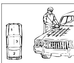
4. При применении промышленного удлинительного провода, перед началом работы, проверить его на отсутствие механических повреждений, перебросить через плечо, таким образом, чтобы избежать его повреждения при работе.
