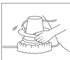
3. Включать и выключать полировальную машину только когда она находится на полируемой поверхности.
