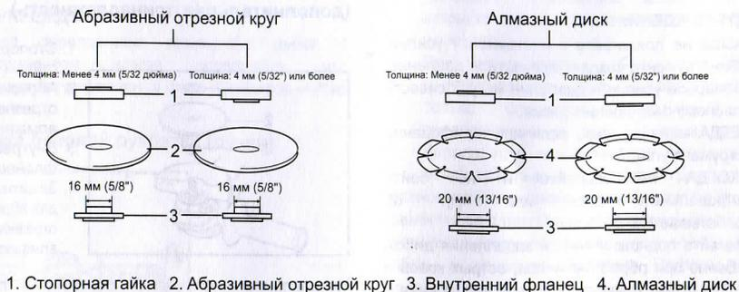
1. Стопорная гайка 2. Абразивный отрезной круг 3. Внутренний фланец 4. Алмазный диск
