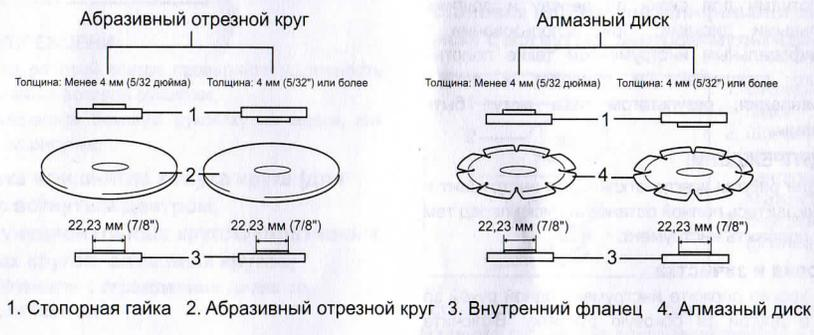
1. Стопорная гайка 2. Абразивный отрезной круг 3. Внутренний фланец 4. Алмазный диск
